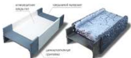
Образец с огнезащитным покрытием «до» и «после» воздействия огня
